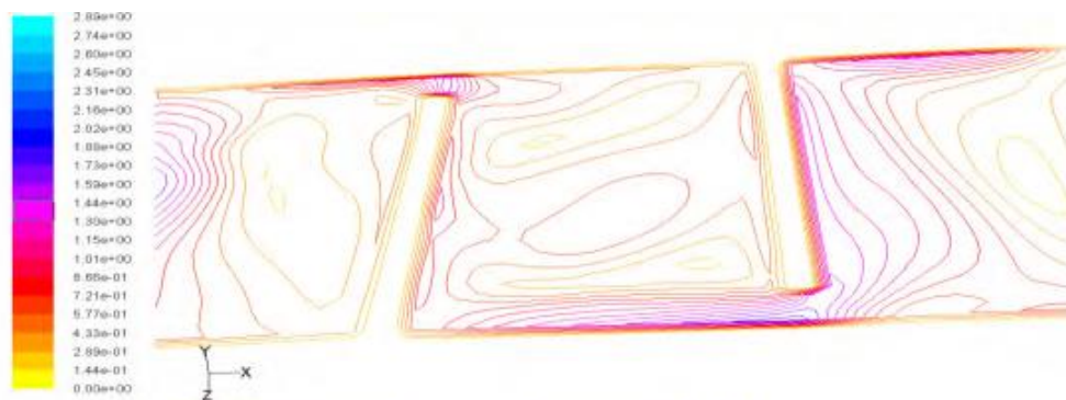
شکل ۳- نمایش خطوط سرعت در استخر چهارم راه ماهی
