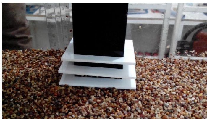
شکل ۲- نحوه قرارگیری پره‌های استفاده شده در مدل آزمایشگاهی
