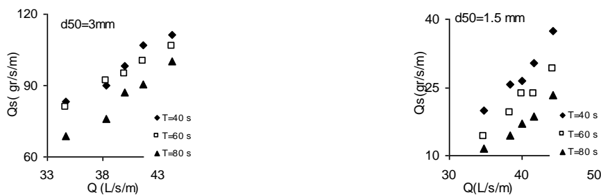
شکل ۵. دبی متوسط بار کف در برابر دبی جریان در دونوع دانه بندی
